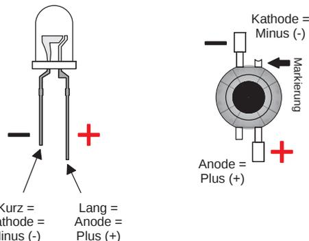
LEDs sollten, außer in speziellen Fällen, nie ohne einen schützenden Vorwiderstand R betrieben werden. LEDs benötigen nur sehr geringe Spannungen und Ströme und brennen ohne einen Vorwiderstand sehr schnell durch. Nur mit passendem Vorwiderstand ist eine lange Lebensdauer gewährleistet!
